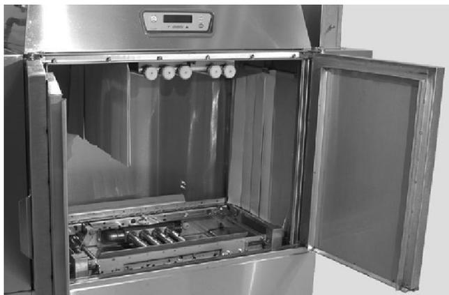
Las puertas aisladas de inspección con bisagras brindan un fácil acceso a la cámara. Las tuberías de lavado exteriores y los reducidos deflectores interiores disminuyen el tiempo de limpieza. El transportador de retorno rápido patentado brinda una amplia separación entre la zona de lavado y enjuague.
