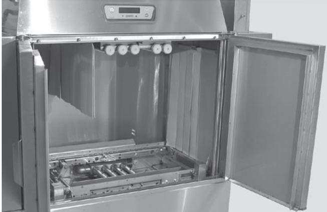
Las puertas aisladas de inspección con bisagras brindan un fácil acceso en la cámara. Las tuberías exteriores de lavado y los reducidos deflectores interiores disminuyen el tiempo de limpieza. El mecanismo motriz de rápido regreso del transportador brinda una amplia separación entre la zona de lavado y enjuague.
