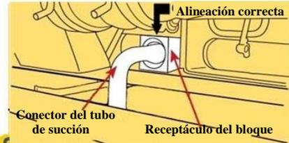
**2** Abra las puertas de la freidora y revise que el tanque del filtro esté cerrado debajo de la freidora y conectado con el conector del tubo de succión y el receptáculo. **Alineación correcta**
