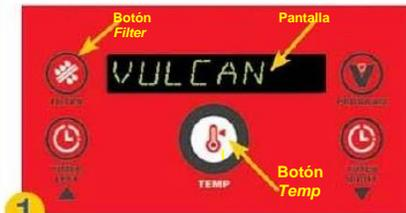
**1** Asegúrese que el interruptor *Power* esté en la posición *ON*. La freidora debe tener corriente eléctrica para operar la bomba. La temperatura de la freidora debe estar entre 300 a 350°F. Se recomienda agregar un medio de tratamiento de aceite.
