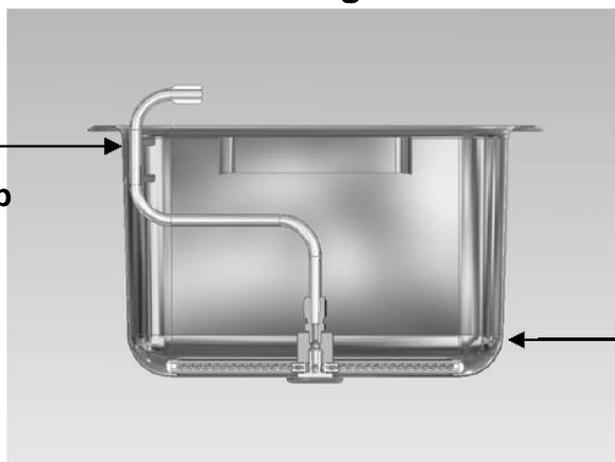
La malla filtrante se coloca en el fondo del depósito del filtro
