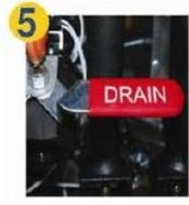
Cierre la válvula de drenado poco a poco y deje que el tanque se llene con aceite limpio. En este punto, no se encenderán los quemadores o las resistencias. Deje que el aceite que está en el depósito del filtro regrese al tanque. Es normal ver algunas burbujas de aire durante este proceso.
