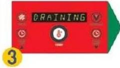
**3** Abra la válvula de drenado para dejar que el aceite se drene en el depósito del filtro. Los quemadores se apagaran de manera automática. Mientras drene el tanque, use el cepillo para llevar los residuos del fondo y de los lados del tanque hacia el tubo de drenado.
