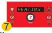
**7** Luego de presionar el botón *Temp*, la freidora seguirá con el calentamiento. Se mostrará en la pantalla la palabra *Heating*
