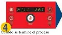
**4** Cuando se termine el proceso de filtración, cierre la válvula de drenado roja girando la manija de la válvula. Aparecerá en la pantalla las palabras *Fill vat*.
