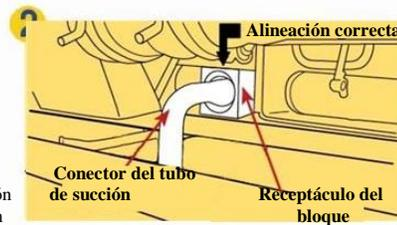
Abra las puertas de la freidora y revise que el tanque del filtro esté cerrado debajo de la freidora y conectado con el conector del tubo de succión y el receptáculo.
